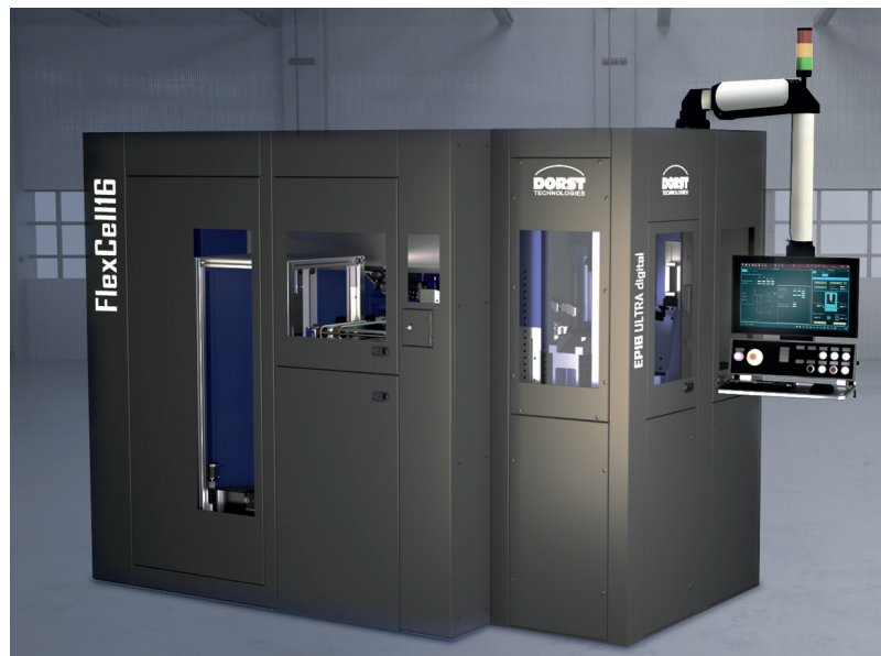
Bild 1 FlexCell16 – Presse und Teileentnahme – vollintegriert
