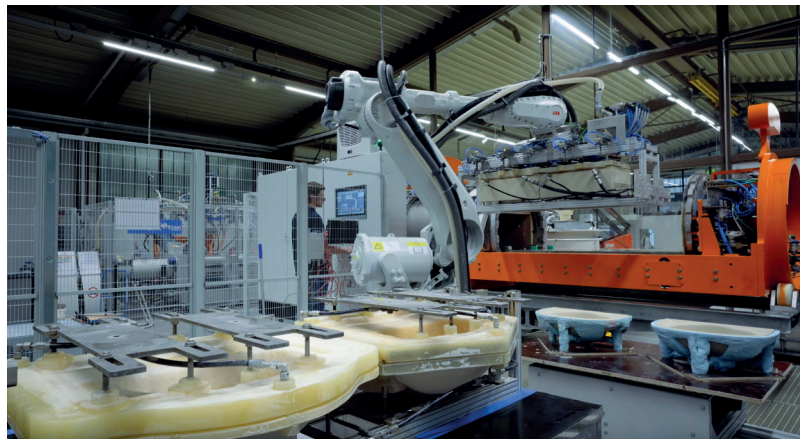
Bild 4 Roboterinheit des Produktionssystems während des Formenwechsels an der DORST COMPACTCAST 300
